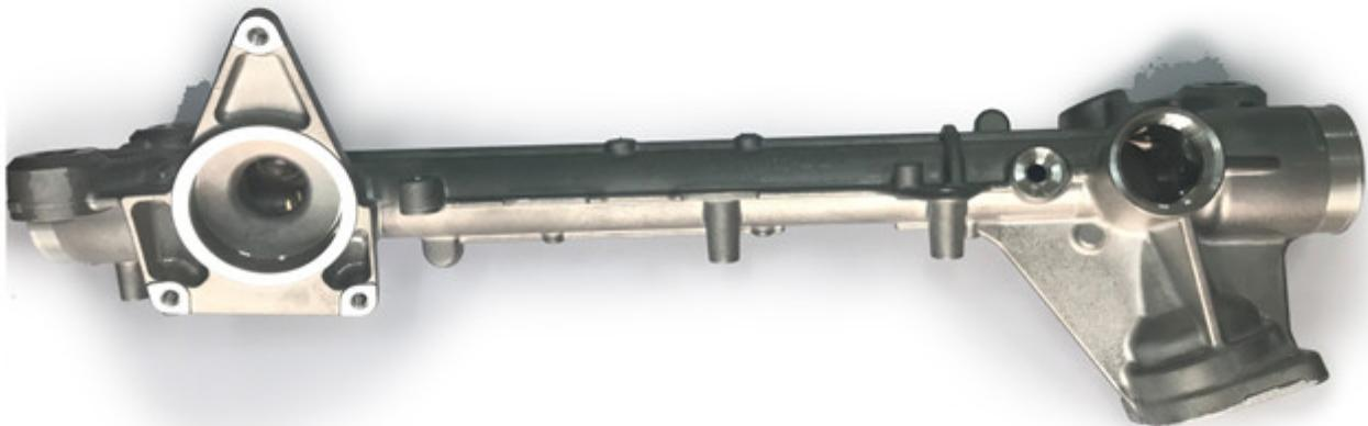
机械式可变转向比系统：它主要是在“齿轮齿条机构”的“齿条”上做文章，通过特殊工艺加工齿距间隙不相等的齿条，这样方向盘转向时，齿轮与齿距不相等的齿条啮合，转向比就会发生变化，中间位置的左右两边齿距较密，齿条在这一范围内的位移较小，在小幅度转向时（例如变线、方向轻微调整时），车辆会显得沉稳，而齿条两侧远端的齿距较疏，在这个范围内，转动方向盘，齿条的相对位移会变大，所以在大幅度转向时（如泊车、掉头等），车轮会变得更加灵活。这种技术除了对齿条的加工工艺要求比较严格之外，并没有多少“高科技”在其中，缺点在于齿比变化范围有限，并且不能灵活变化，而优势也很明显—完全的机械结构，可靠性较高，耐用性好，结构也非常简单。电子式可变转向比系统：科技含量高，相比机械式可变转向比系统，电子式可变转向比系统使用了更复杂的机械结构并且需要与电子系统结合使用。能够更好的实现“低速时轻盈灵敏，高速稳健厚重”的需求，其为车辆行驶带来的便利性和稳定性都是普通的可变助力转向系统和单纯的“机械式”可变齿比转向无法比拟的。转向器厂家，就选上海神富机械科技有限公司，欢迎您的来电！扬州恩斯克转向器公司
